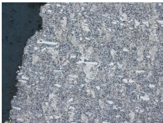
Obr. 37 - Mikrostruktura ECAPované tyče po 1 průchodu v podélném řezu
