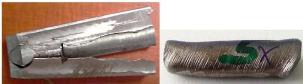
Obr. 45 - Detail odfrézovaného pouzdra po 4 průchodech (vlevo), vzorek X210Cr12 bez pouzdra (vpravo). Na povrchu jsou viditelné skluzové čáry svědčící o tom, že deformace ve stříhových rovinách proběhla úspěšně.
