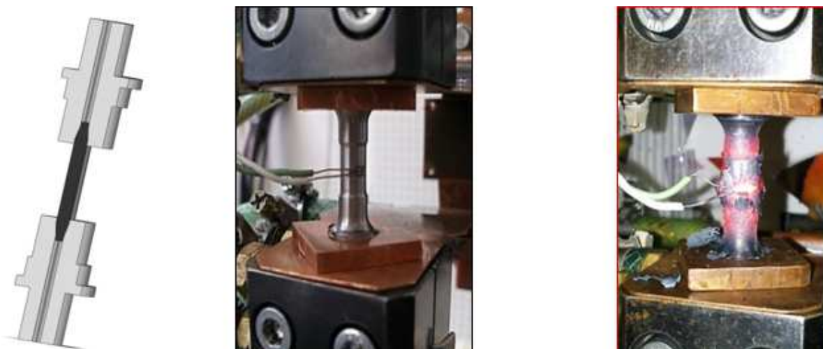
Obr. 20 - Polotovar umístěný v čelistech formy (vlevo), variantní řešení pro zpracování se závitovým uchycením vzorku, před zahájením režimu (uprostřed) a v průběhu zpracování (vpravo).
