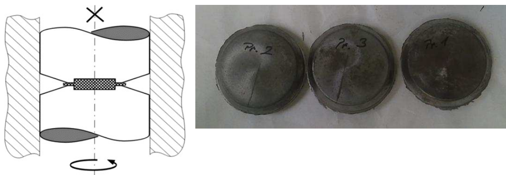
Obr. 28 - Schéma torzního tváření (vlevo) a výsledné polotovary po HPT (vpravo)
