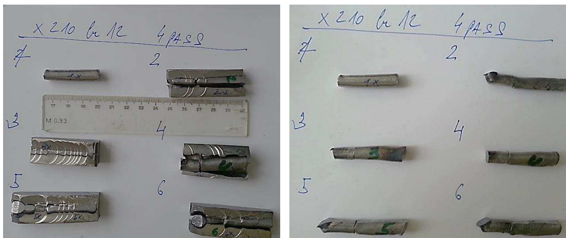
Obr. 44 - Odfrézovaná pouzdra vzorků po 4 průchodech (vlevo), vzorky z X210Cr12 bez pouzdra (vpravo)
