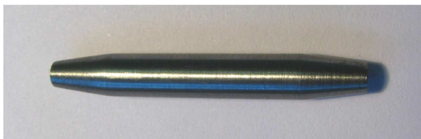
Obr. 53 - Zkušební vzorek pro semi-solid zpracování v zařízení pro minitixoforming
