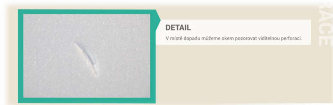
Obrázek 77: Detail deformace polystyrenového táčku.
