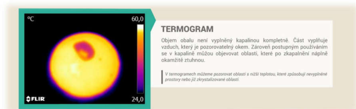
Obrázek 84. Doplnující termogram s jeho interpretací, upozorňující na možné výskyty anomálií oproti předchozímu ideálnímu zobrazení povrchové teploty.
