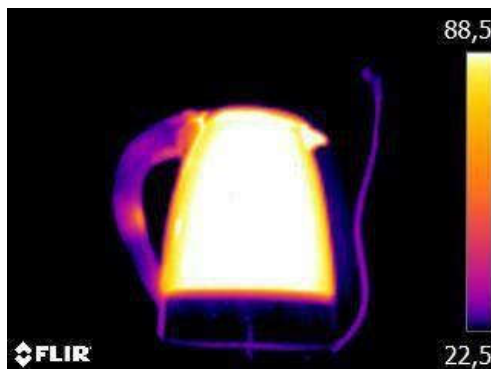
Obrázek 63: Varná konvice jednu minutu po uvedení vody k varu s odpovídající teplotní škálou. Můžeme pozorovat ohřátí přírodního kabelu a rukojeti konvice (obsahující bimetalový spínač).
