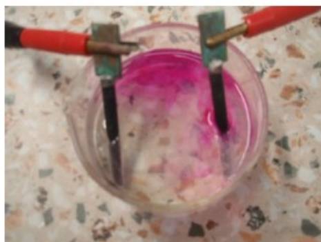
Obr. 45 Elektrolýza vodného roztoku chloridu sodného [27]
