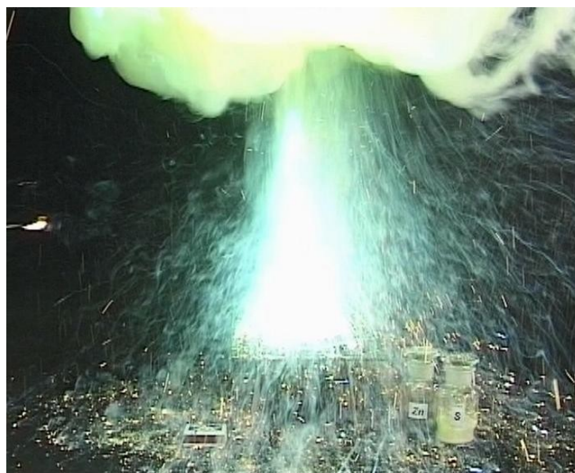
Obr. 52 Reakce zinku se sírou [33]
