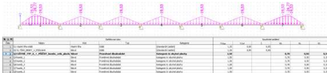
Obrázek 17 Ztížení od typu užívání konstrukce a přiček
