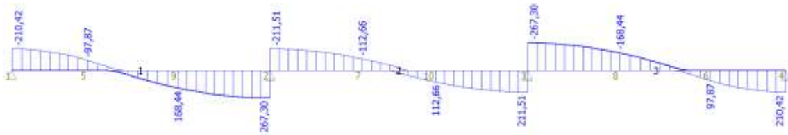
Obrázek 42 Velikost posouvajících sil (příčný směr)
