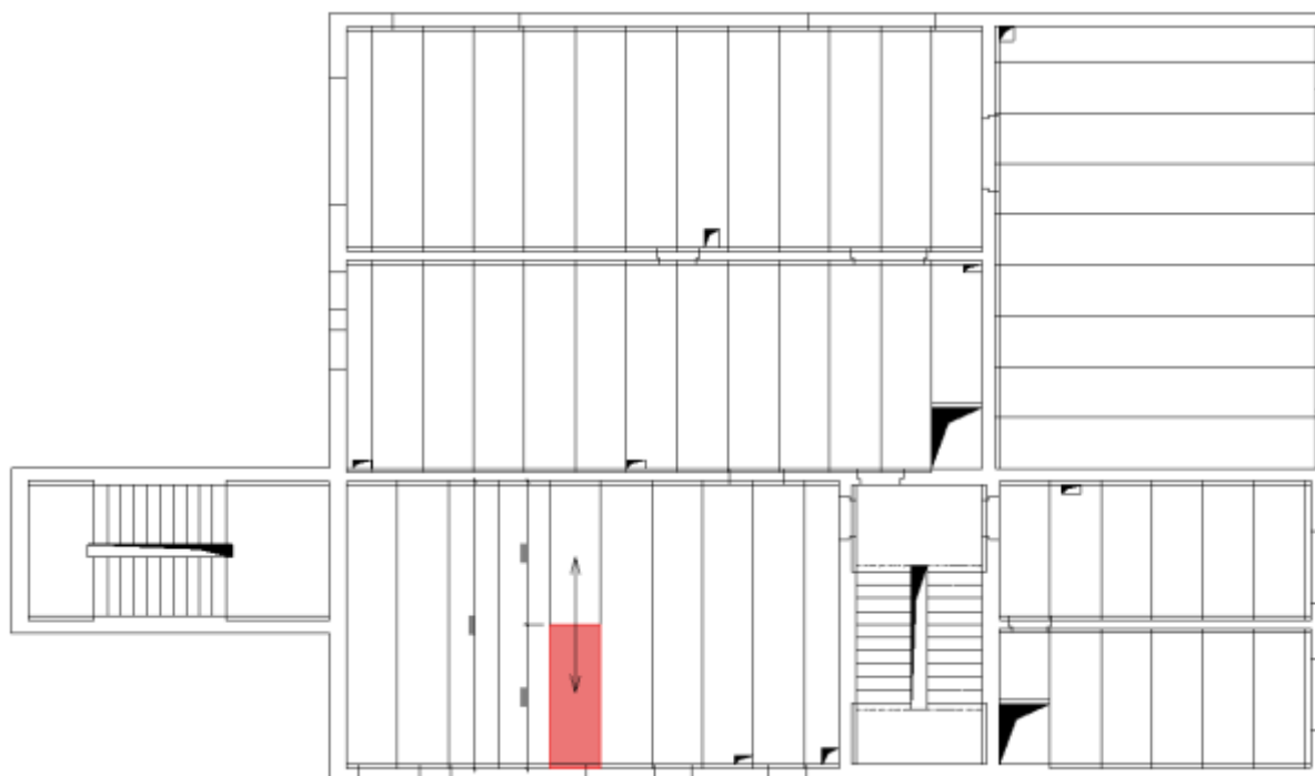
Obr.3: Zatěžovací šířka krajní stěna
