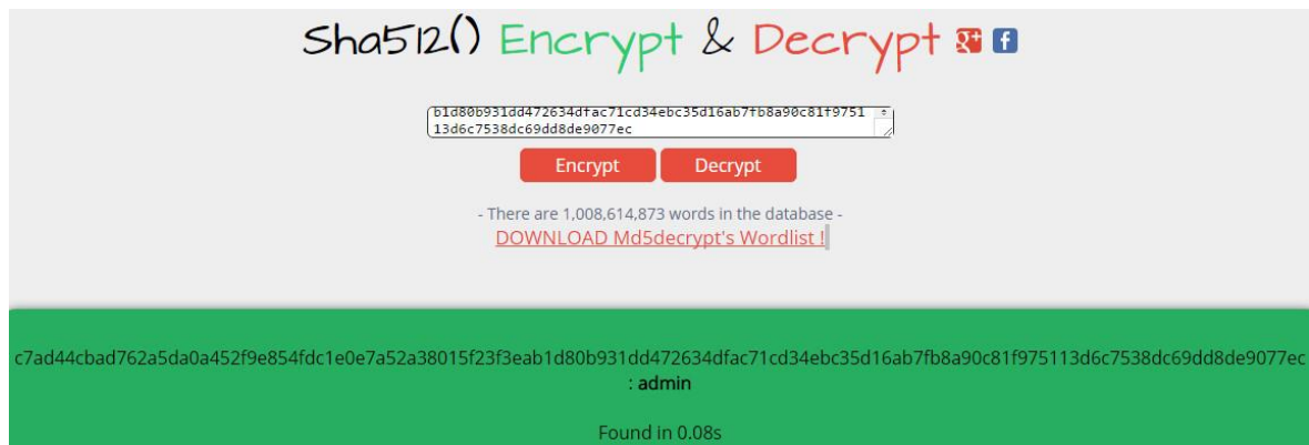
Obrázek 13: Ukázka získání hesla admin pomocí online decryptoru.
