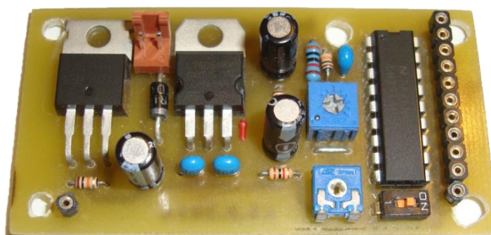
Obr. 3.11 Fotografie bloku indikátoru stavu napětí baterie
