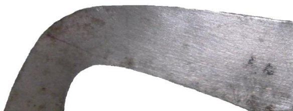
Obr. 15 Šablona přepouštěcího kanálu závodního stroje Malossi
