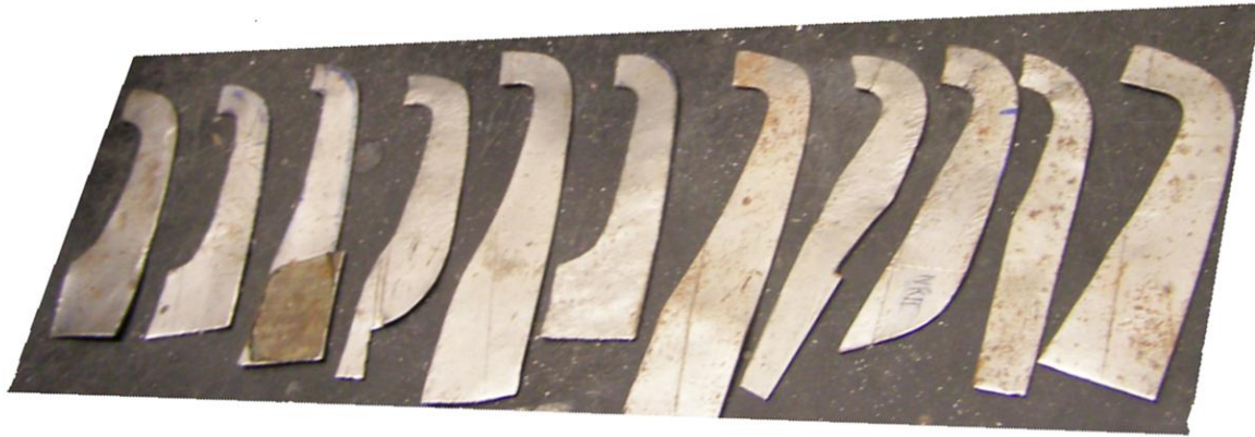
Obr. 26 Plechové šablony s podélnými průřezy závodních válců
