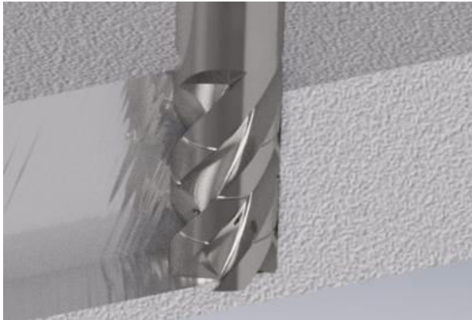
Obr. 21 Frézování bokem frézy se zuby ve šroubovici
