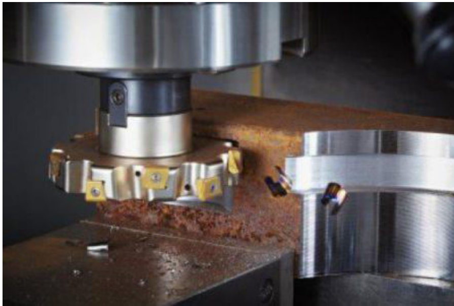
Obr. 10 Výroba drážky kotoučovou frézou
