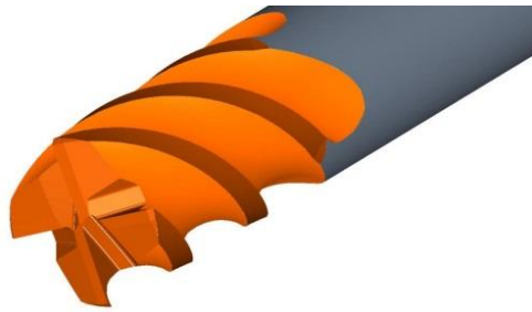
Obr. 71 Ostření čela, drážky i obvodu [28]
