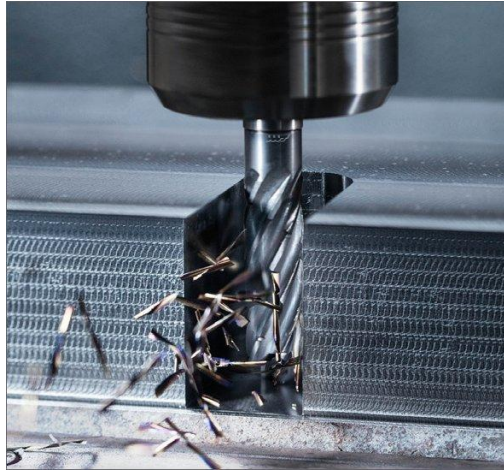
Obr. 39 Frézování bokem frézy [15]
