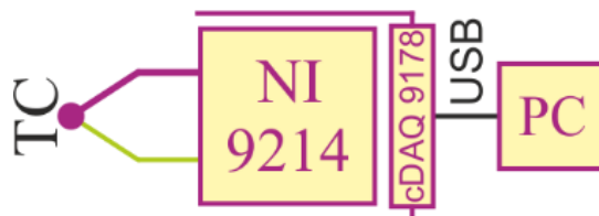
Obr. 8-3: Schéma měření teploty pomocí termočlátku s převodníkem NI 9214 [9]
