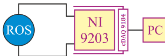
Obr. 9-3: Schéma měřicího řetězce s A/D převodníkem [9]
