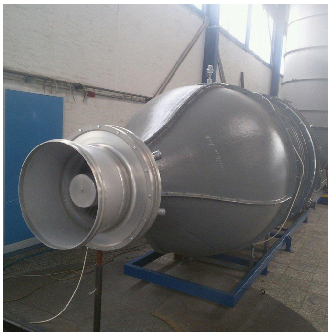
Obr. 5-2: Aerodynamický tunel s modelem výstupního tělesa [6]
