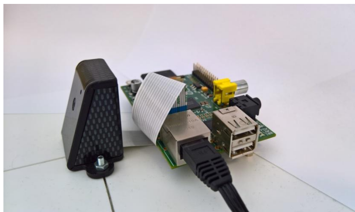
Obr. 10: Původní uchycení kamerových modulů v oficiálně dodávané krabičce.
