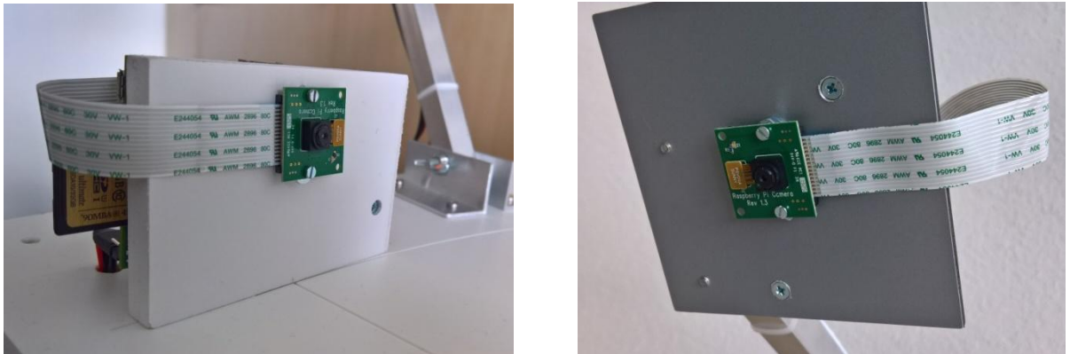
Obr. 16: Způsob uchycení kamer ve finálním výrobku
