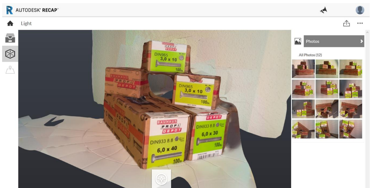
Obr. 9: Program Recap360 pro rekonstrukci modelu objektu
