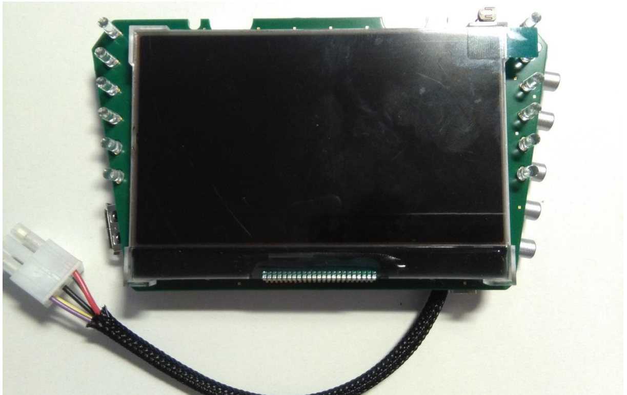
Obr. č. 52 Plošný spoj zobrazovacího panelu – pohled na přední stranu
