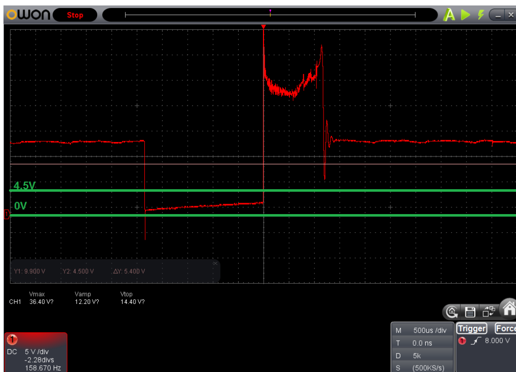
Obr. č. 9 Průběh napětí na primární straně zapalovací cívky a měřící hladina - BMW F650GS, ročník 2005
