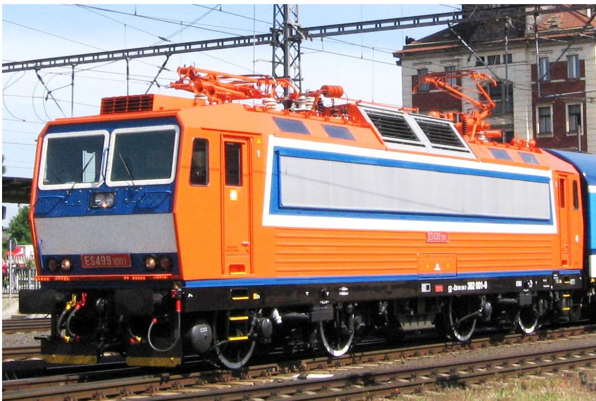
Obr. 1.2. Prototyp lokomotivy ES 499.1001 (1980). Nyní zařazen do provozu jako ř. 362.001.[1]
