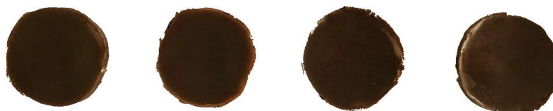
Obr. 3.5.1 – Vzorok směsi magnetické kapaliny a silikonu A: 0.1 ml / 7 g, B: 0.15 ml / 7 g, C: 0.3 ml / 7 g, D: 0.4 ml / 7 g
