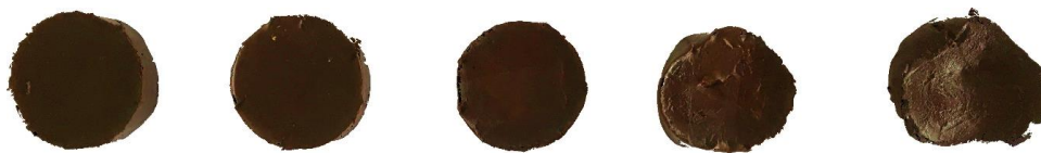
Obr. 3.5.3 – Vzorok směsi magnetické kapaliny a silikonu (popis zprava) A: 1.4 ml / 7 g, B: 1.6 ml / 7 g, C: 1.8 ml / 7 g, D: 2.0 ml / 7 g, E: 2.2 ml / 7 g
