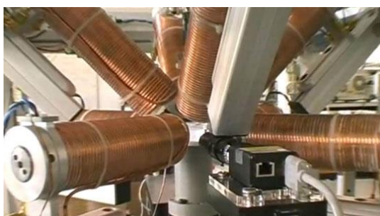
Obr. 1.1.1 – Manipulační systém Octomag [2]
