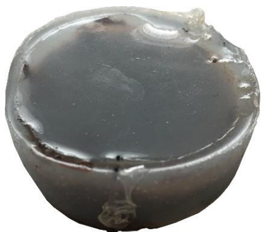
Obr. C.12 – Silikonová nádoba s magnetickou kapalinou
