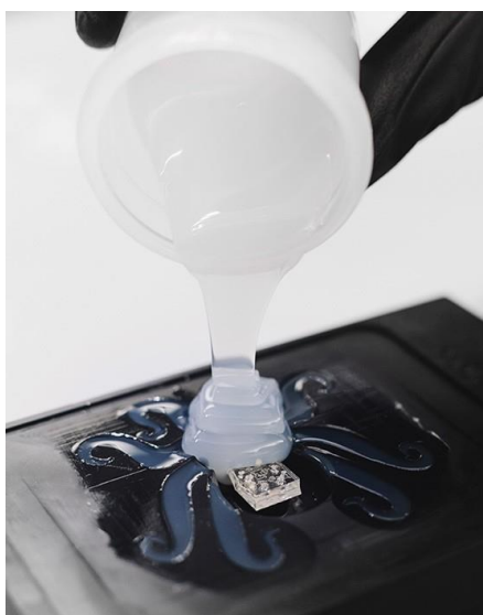
Obr. 1.5.2 – Odlévání silikonového těla [9]
