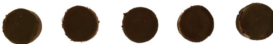
Obr. 3.5.2 – Vzorok směsi magnetické kapaliny a silikonu A: 0.4 ml / 7 g, B: 0.5 ml / 7 g, C: 0.6 ml / 7 g, D: 0.8 ml / 7 g, E: 1.0 ml / 7 g
