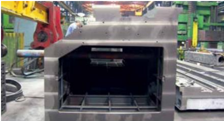
Obrázek 7- Opracovaný odlitek stojanu stroje HCW [4]
