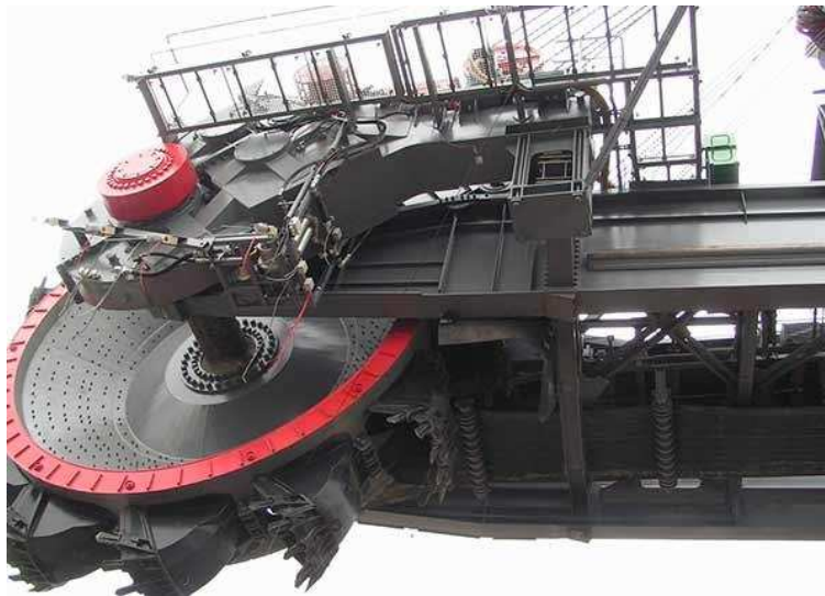
Obr.: 4-1 Pohled na pohon kola rýpadla KU 300 [30]
