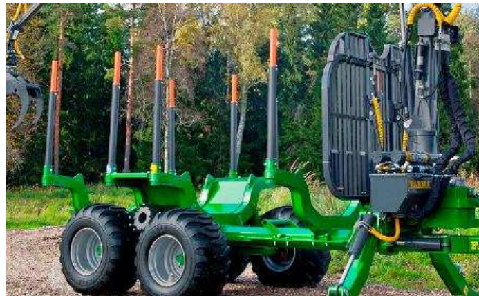
Obrázek 22 Výškově nastavitelné klanice [26]
