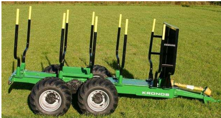
Obrázek 9 Žebřinový rám vyvážecího vleku [13]
