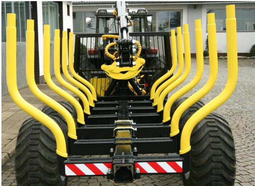
Obrázek 8 Páteřový rám vyvážecího vleku [12]
