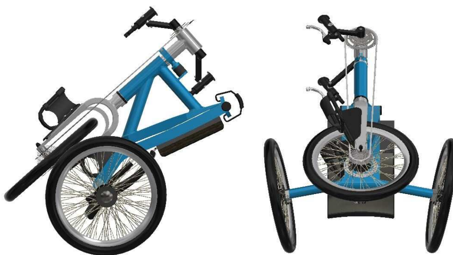
Obrázek 62 Varianta 2 - Sestava handbiku ve složeném stavu
