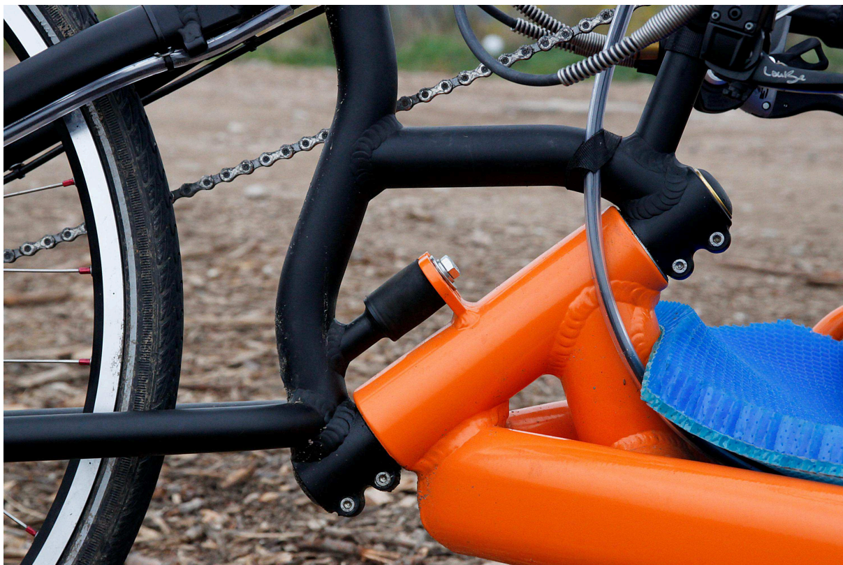
Obrázek 31 Pevné spojení vidlice s rámem uprostřed se silentblokem
