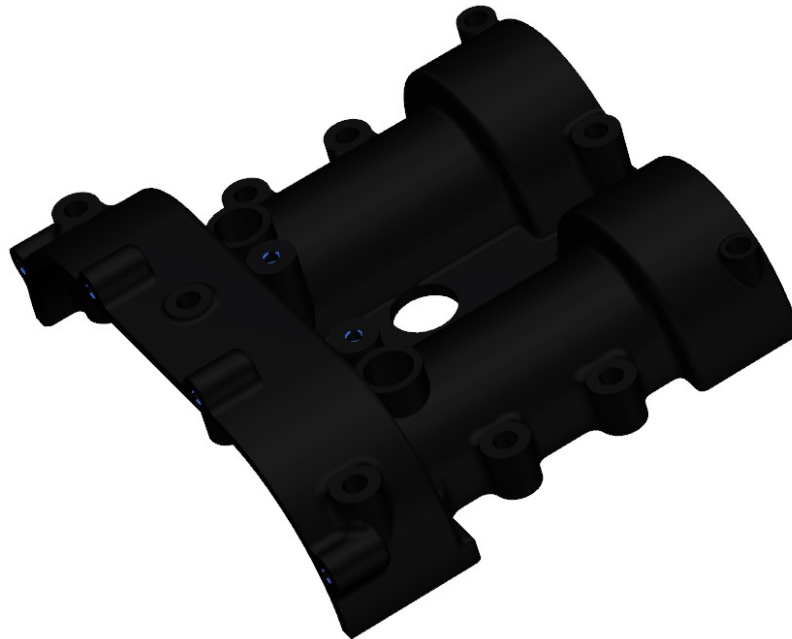
Obr. 97 - Víko hlavy válce motoru
