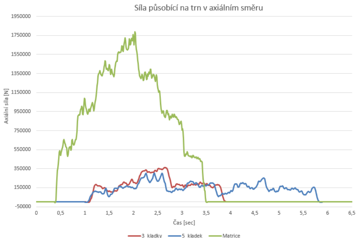
Obrázek 41. Průběh výsledných sil působících na trn - axiální směr
