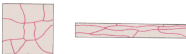
Obrázek 5. Zrno před tvářením a po tváření [12]
