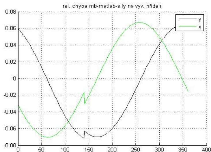
Obr. 36 - průběh odchylky matematického modelu od multibody simulace
