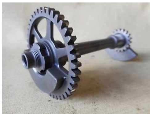
Obr. 9 - vyvažovací hřídel jednoválcového motoru
