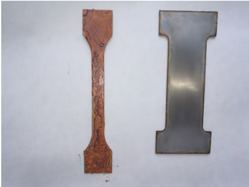
Obrázek 20 - Rozdíl korozní odolnosti ocelí třídy 11 a 17
