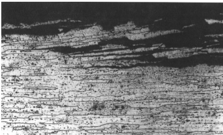
Obrázek 22 - Proces šíření vrstvené koroze po hranicích tvářením prodloužených zrn a následným jevem vystupování materiálu z povrchu [36]
