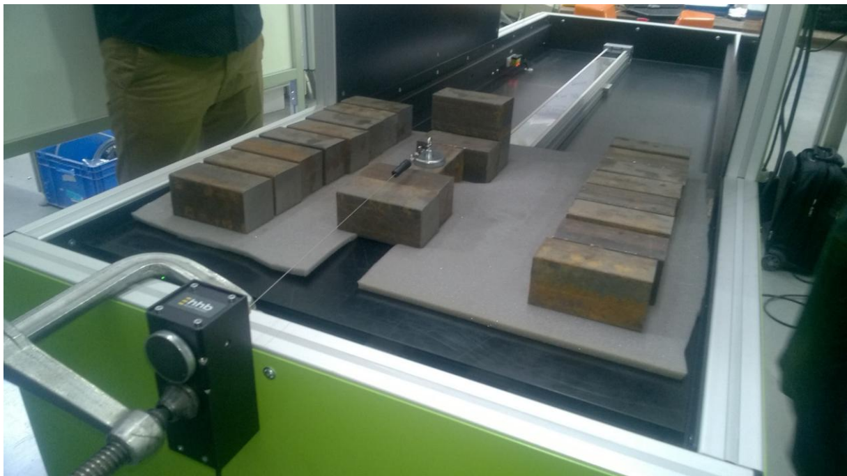
Obr. 8-4 Měření reakční doby elektrického posuvného stolu [5]
