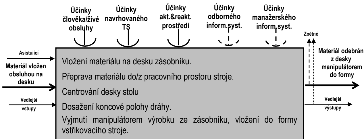
Obr. 8-2 Technologický princip provozního technického procesu [6]
