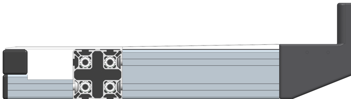
Obr. 10.6 Boční pohled na část rámu s kluznými plochami a dorazy
