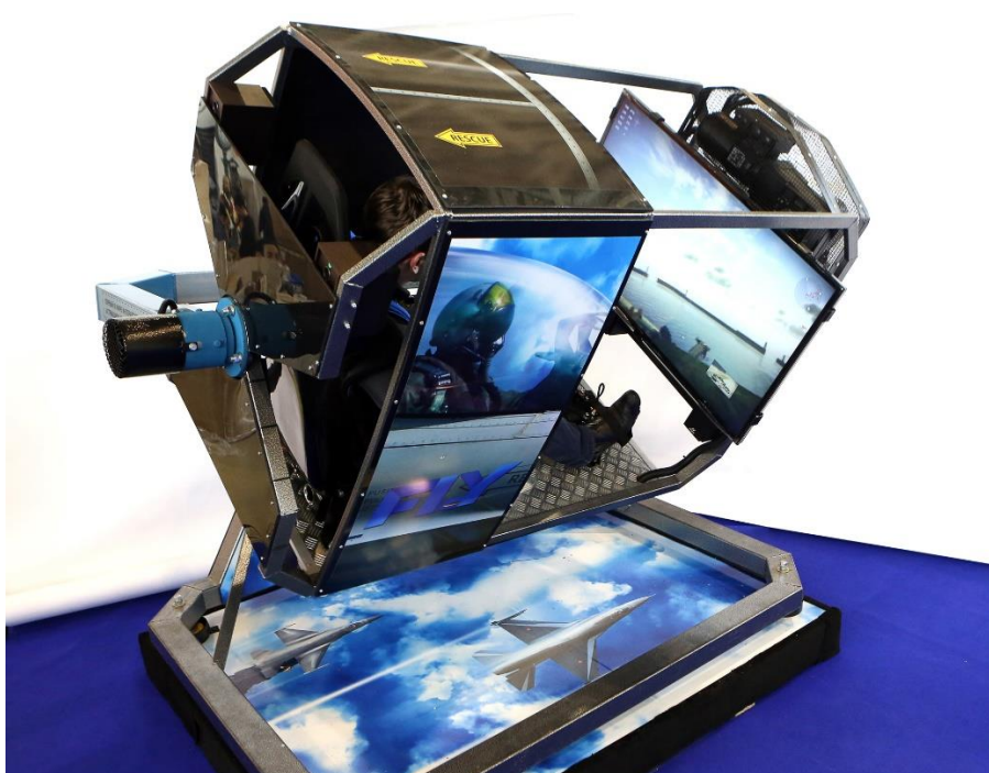
Obrázek 20: simulátor cockpitu letadla - příklad klasické koncepce s otevřeným rámem [17]
