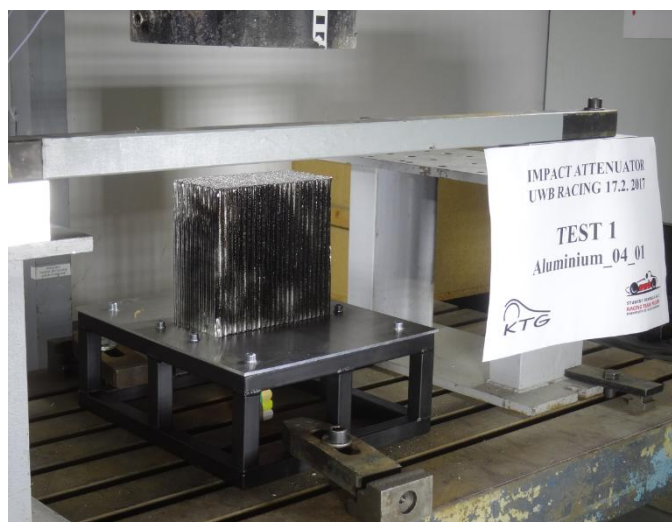
Obrázek 48 - Dynamická zkouška - příprava
