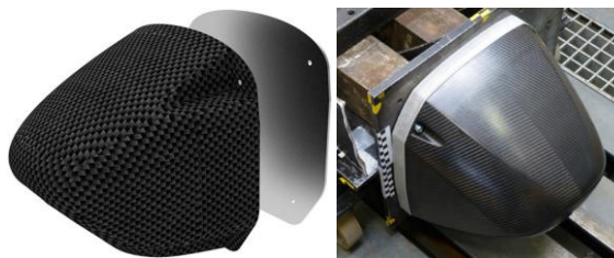
Obrázek 10 - Integrovaný deformační člen - strukturální nos
