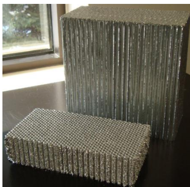
Obrázek 26 - Návrh deformačního členu - materiál hliníkový - Varianta 1
