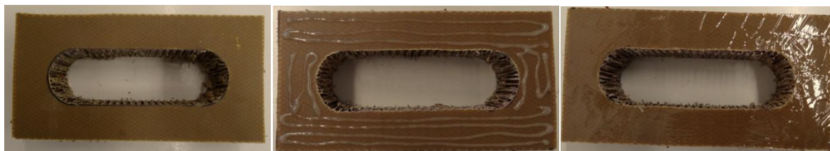
Obrázek 45 - Aramidový deformační člen - lepení
