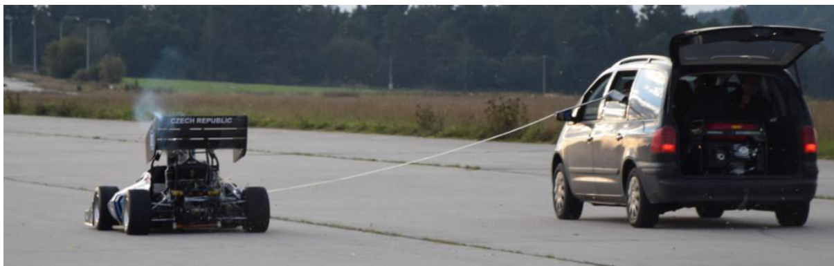
Obrázek 49 Pohled na průběh testování - vizualizace pomocí kouře
