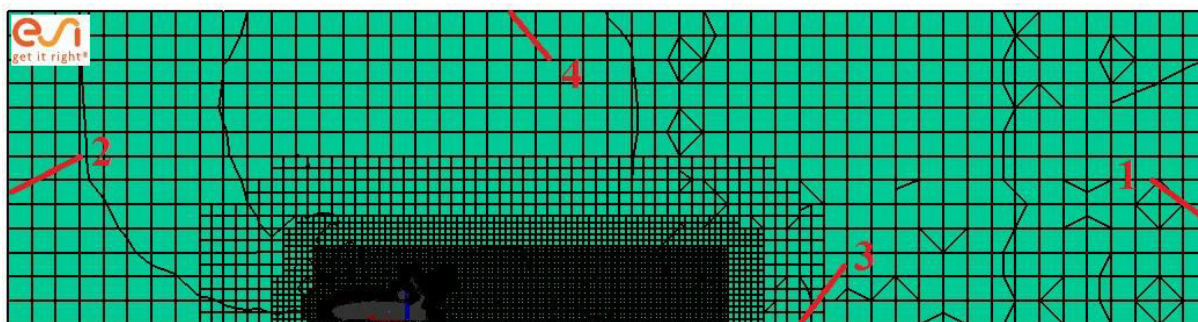
Obrázek 64 Popis jednotlivých oblastí při řešení 3D simulací včetně ukázky diskretizace sítě
