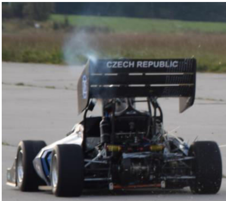
Obrázek 50 Snímek z měření - vizualizace pomocí kouře (při rychlosti 80 km/h)
