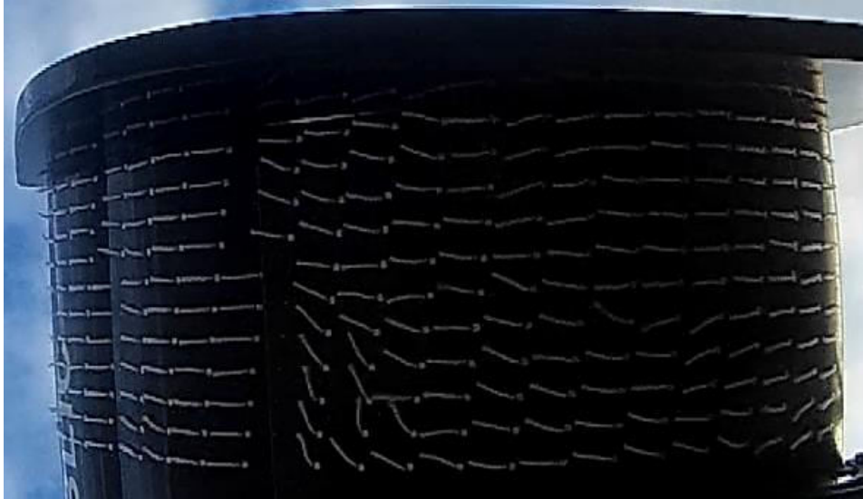
Obrázek 47 Snímek z měření - vizualizace pomocí bavlnek (při rychlosti 80 km/h)
