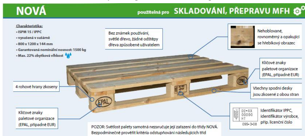
Obr. č. 7: Klasifikace kvality EUR palet EPAL – nová paleta
