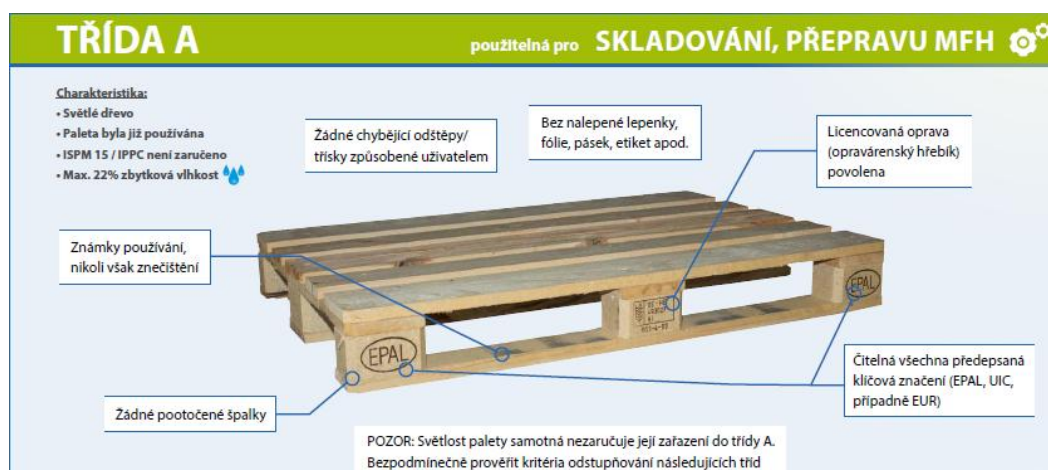
Obr. č. 8: Klasifikace kvality EUR palet EPAL – třída A
