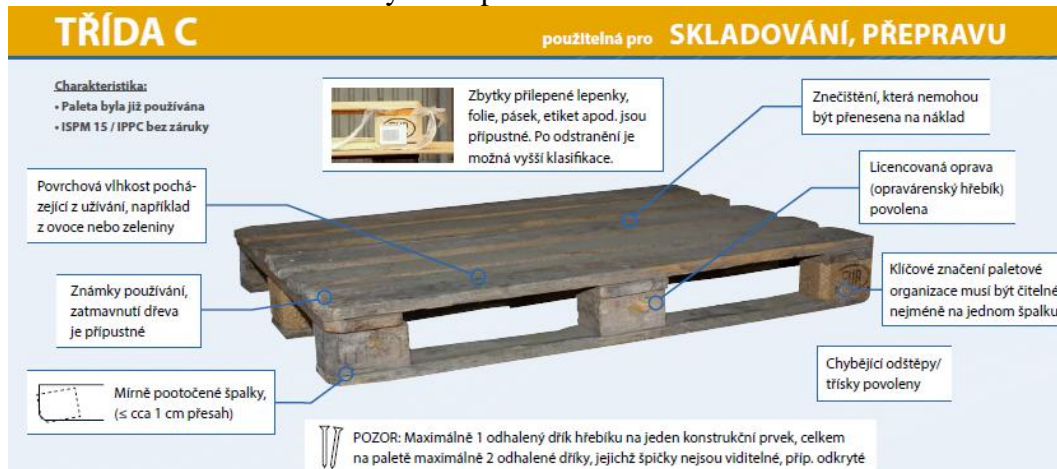
Obr. č. 10: Klasifikace kvality EUR palet EPAL – třída C
