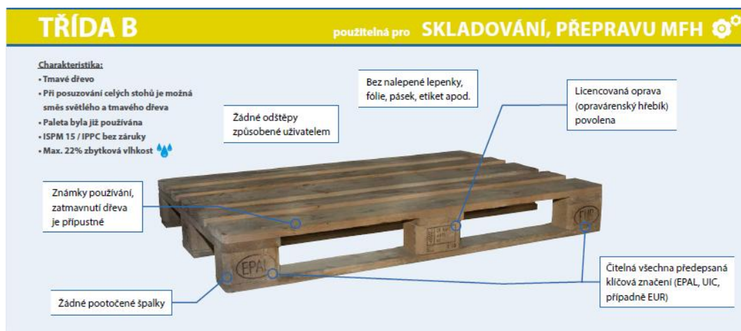
Obr. č. 9: Klasifikace kvality EUR palet EPAL – třída B
