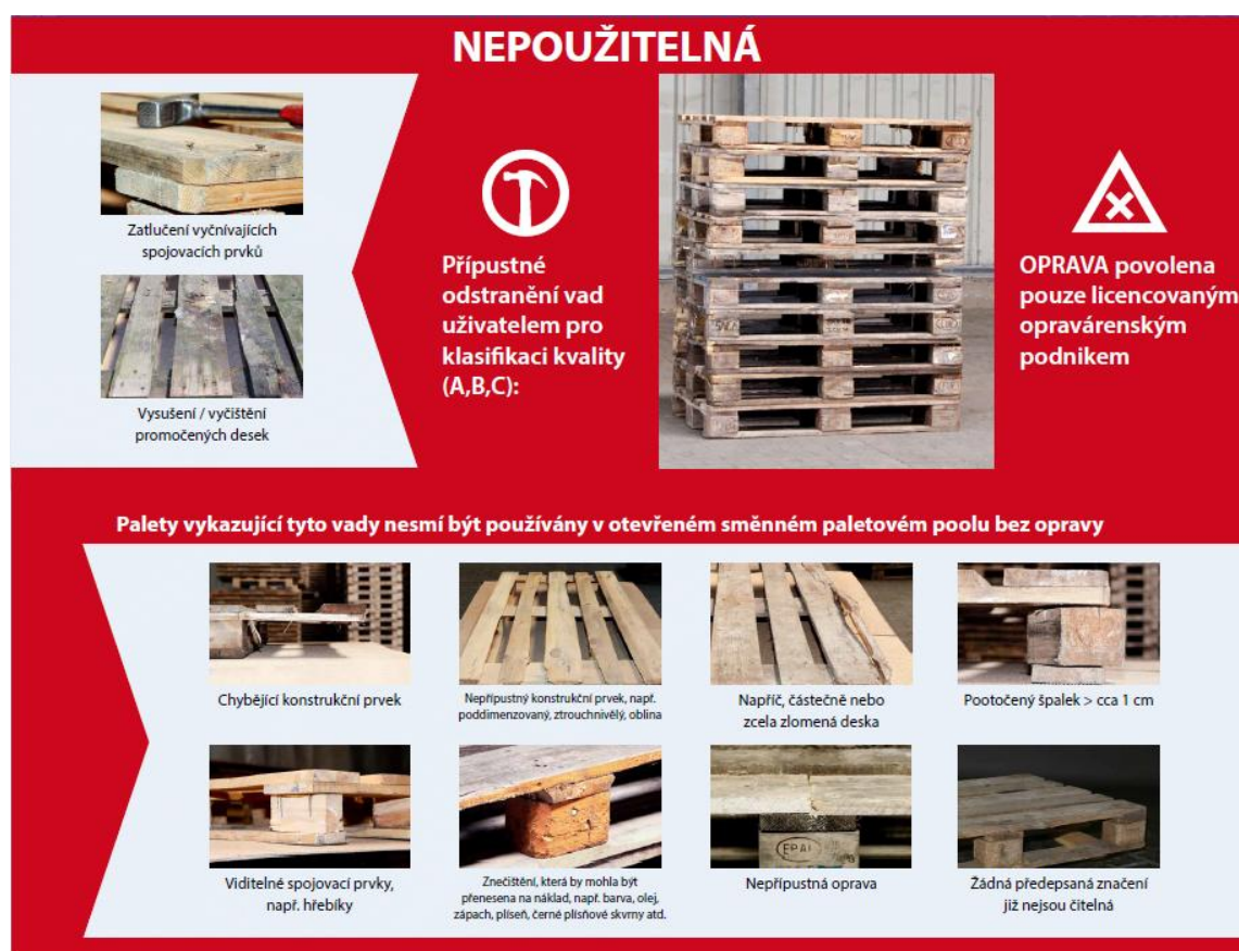
Obr. č. 11: Klasifikace kvality EUR palet EPAL – nepoužitelná paleta
