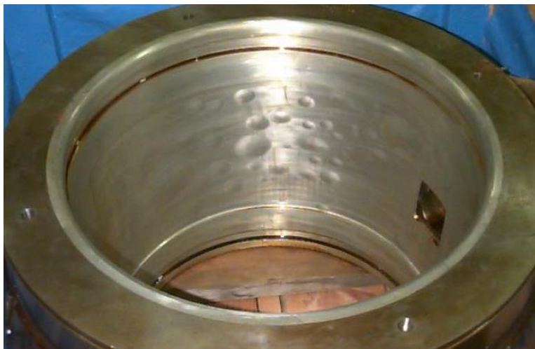
Obr. č. 6: Vodíkové puchýře v kompozici
