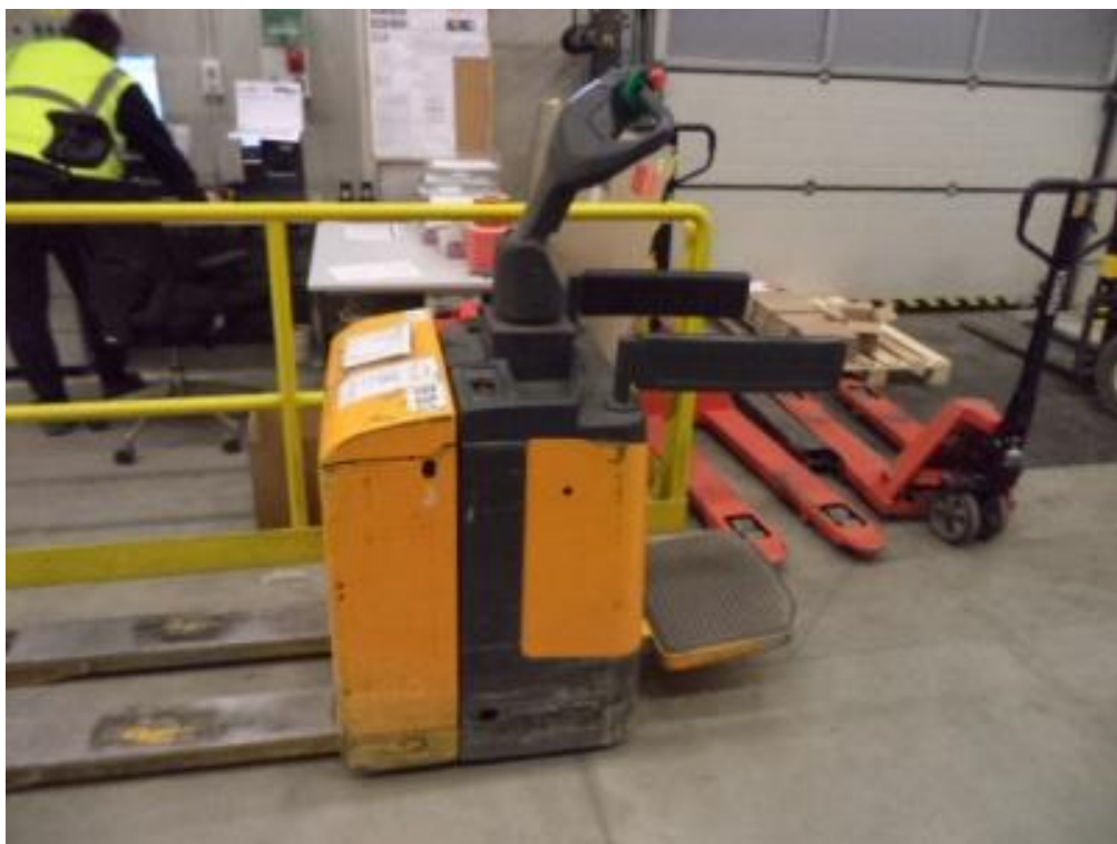
Obrázek 20 Nízkozdvižný vozík používaný při vykládce či nakládce
