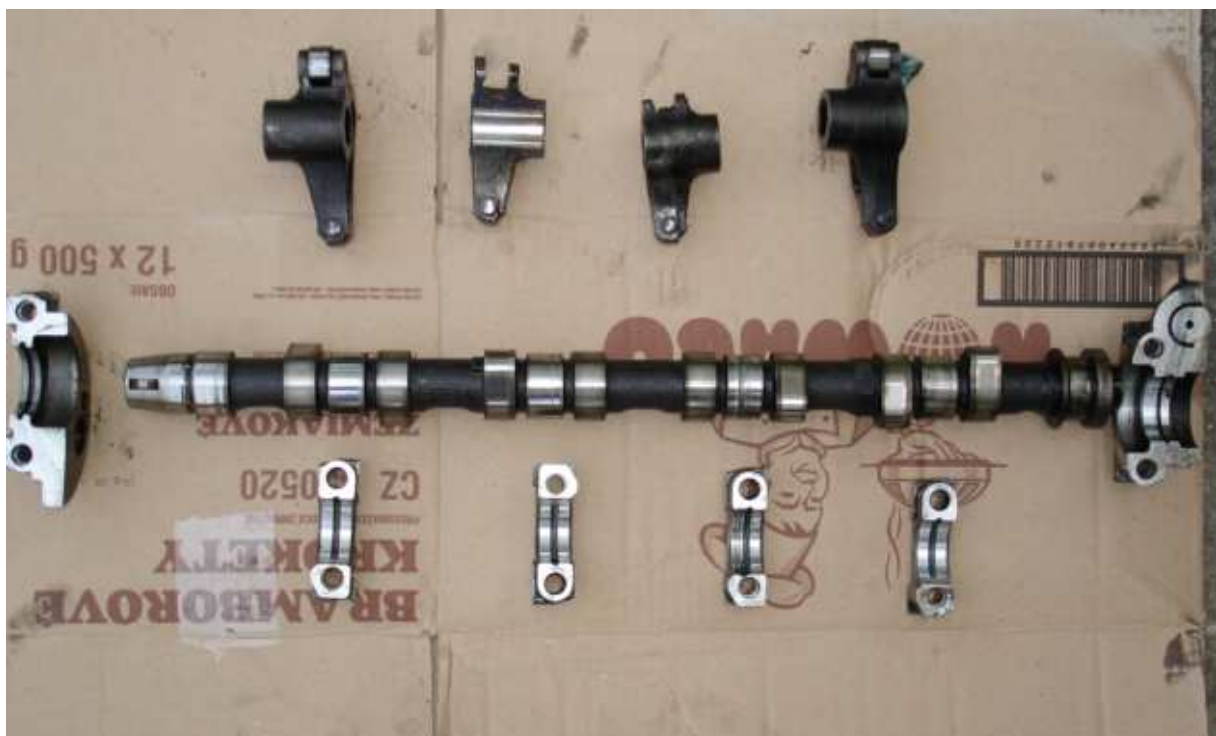
Obr. 6 – 3. Přidřená vačková hřídel
