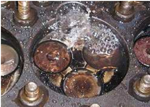
Obr. 6 – 2. Propálená hlava válců
