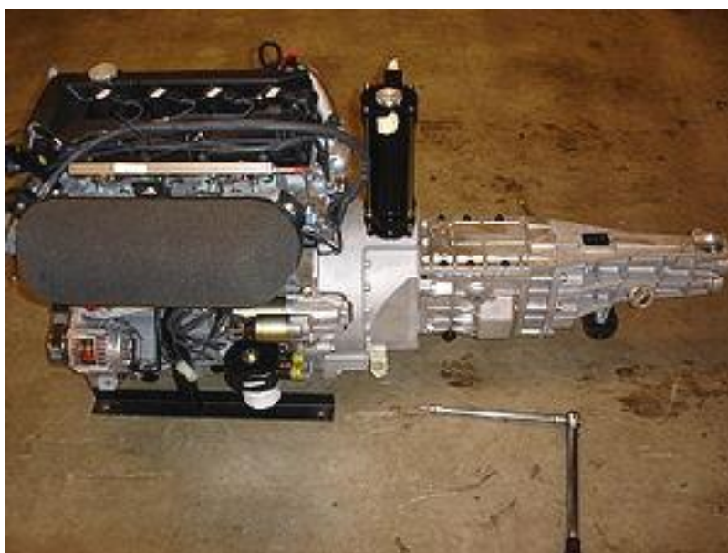
Obr. 55 Motor Cosworth s převodkou [25]
