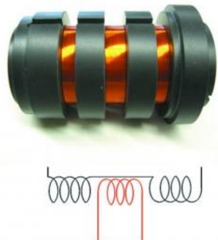
Obr. 1.9 – Magnetický senzor znečištění [11]
