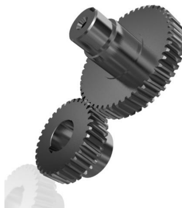
Obr. 1 Čelní soukolí, rotační-rotační přenos
