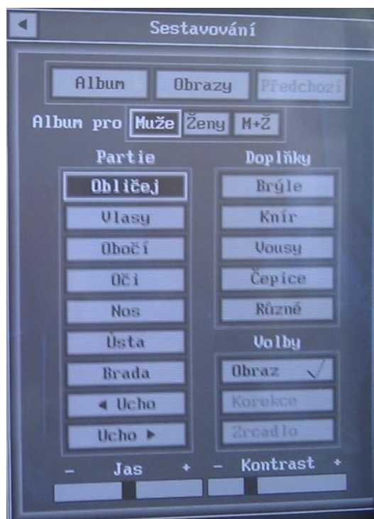
Obrázek 3.2: Ukázka menu současného programu. Sloupeček s partiemi a doplňky představuje vrstvy, které se překrývají v předem daném logickém pořadí. Po kliknutí na určitou partii se zobrazí další menu s výběrem příslušných komponent z databáze.
