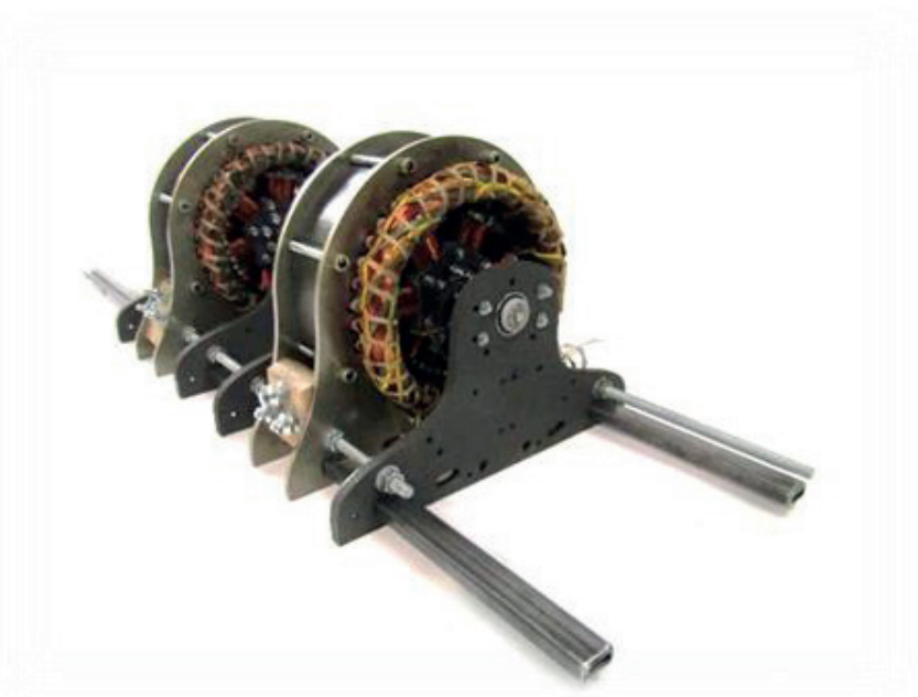
Obrázek III. Foto synchronního soustrojí
