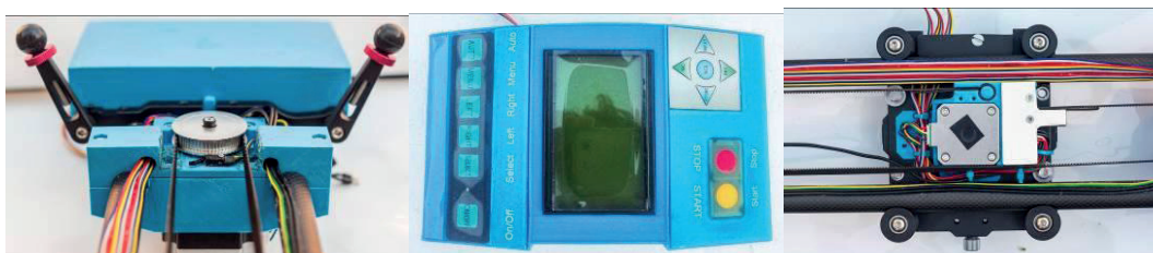
Obrázek II. Zhotovení částí – Tažná řemenice vozíku, víčko krabičky s ovládacími prvky, modul uchycení řemene a motoru rotace
