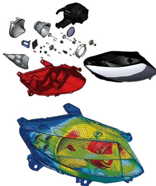
Obr. 6: FloEFD je výkonný nástroj umožňujúci komplexné CFD simulácie (kondenzácia, námraza a ich vývoj v čase) zložitých systémov.
