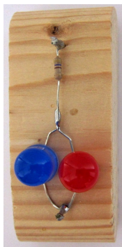
Obr. 1 Jednoduchá pomůcka se dvěma antiparalelně zapojenými LED (pro napájení z baterie 4,5 V nebo méně)
