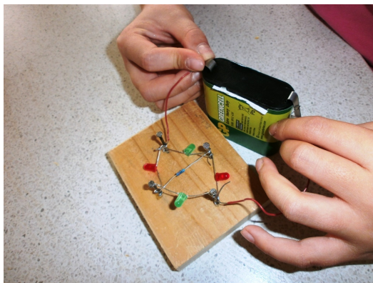
Obr. 10 Graetzův můstek vyrobený žáky
