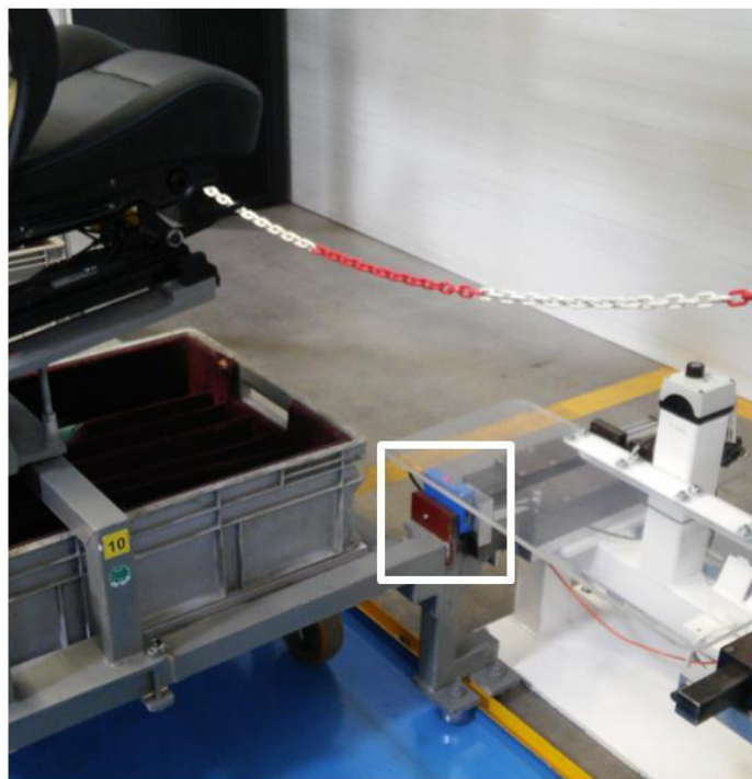
Obrázek 58: Detail RFID čtečky se spojením s RFID kartou [vlastní]
