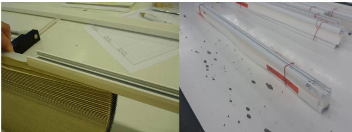
Obr. 26: Proces nasazování profilů na látku
