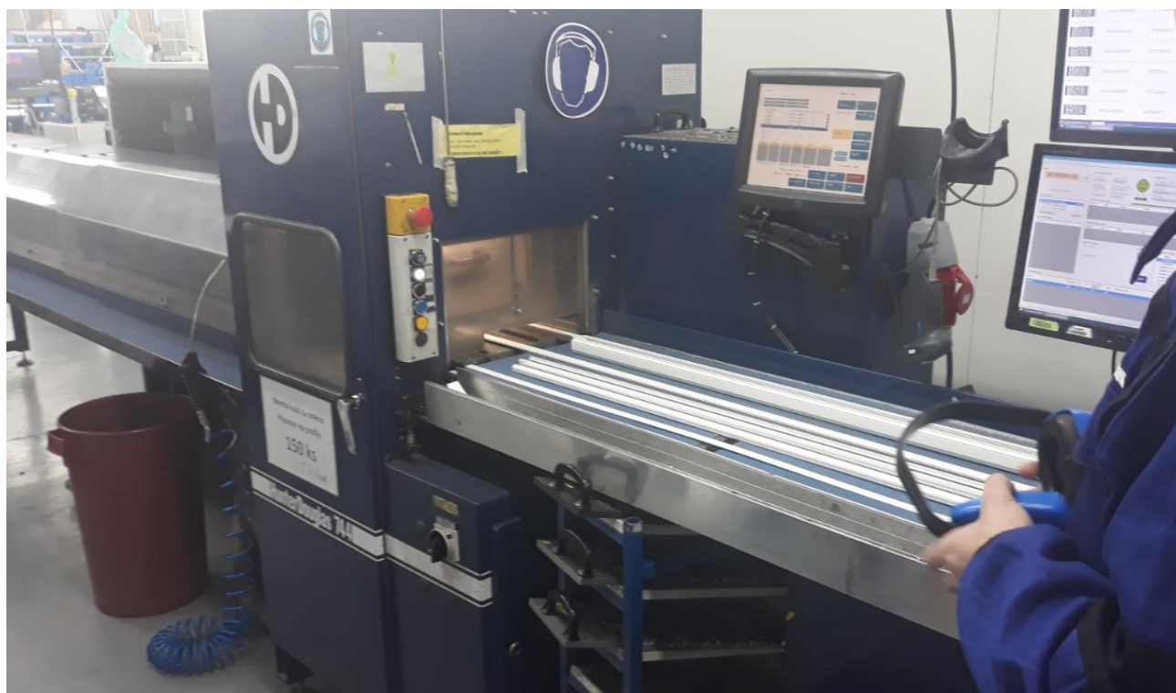
Obr. 23: Pracoviště řezání profilů
