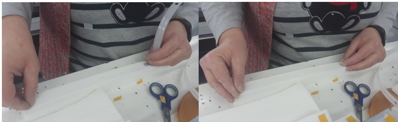
Obr. 25: Proces lepení plastu na látku
