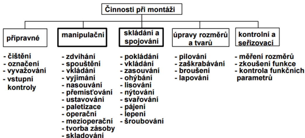
Obrázek 2-1 Činnosti při montáži [2]
