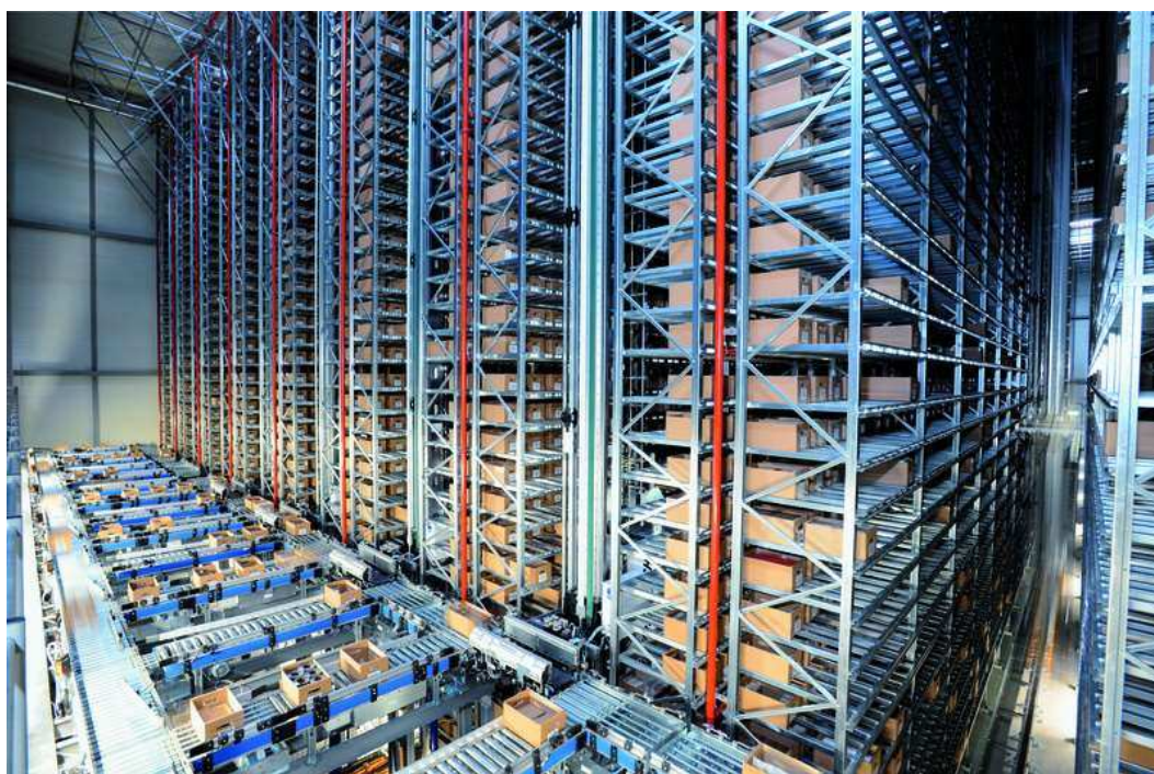
Obrázek 2-11 Automatizovaný sklad pro dorbné díly [13]
