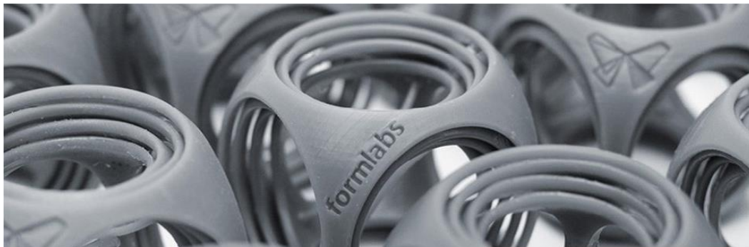
Obrázek 8: Objekty vytisknuté na tiskárně Form1
