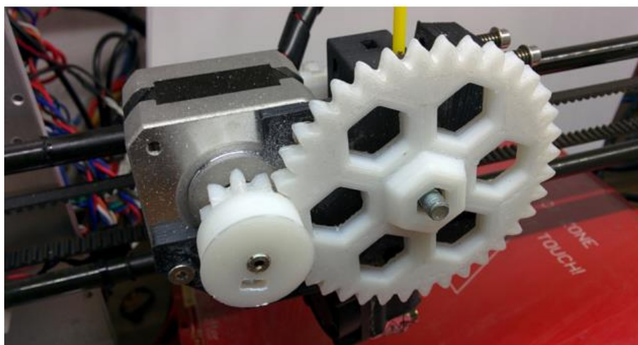
Obrázek 6: Převodovka po několika měsících aktivního užívání.
