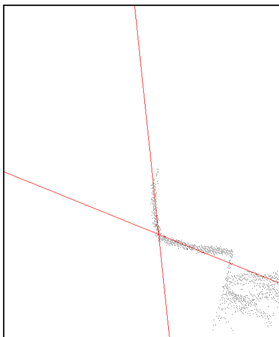
Obrázek 31: Přímky nalezené pomocí HT (první profil)
