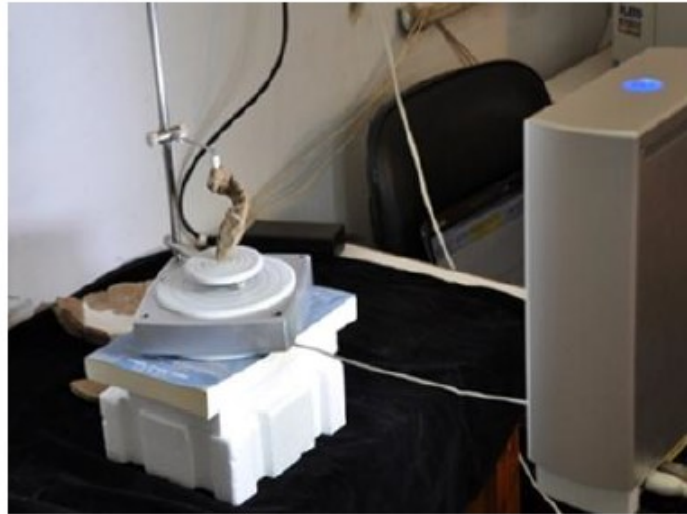
Obr. 2: Upevněný střep nádoby na rotačním zařízení při skenování laserovým skenerem NextEngine 3D Desktop. [3]
