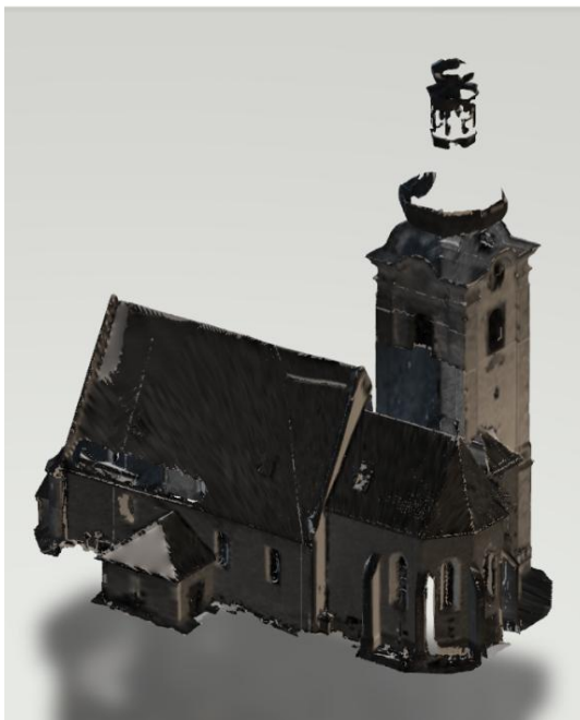
Obr. 4.2 Lokální prezentace virtuálních 3D modelů v programu 3D Paint : virtuální 3D model z dat získaných a) klasickými geodetickými metodami, b) z technické dokumentace, c) laserovým skenováním, d) z fotografií.
