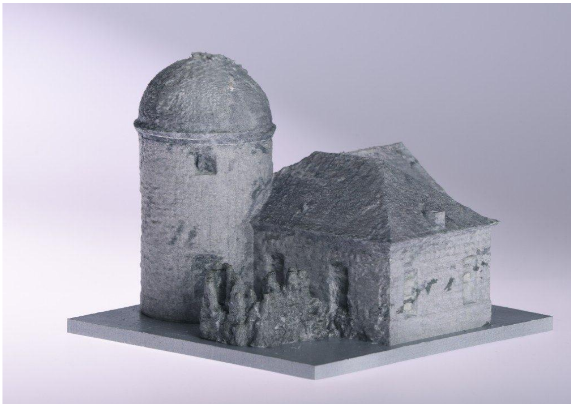
Obr. 2.6 Papírový fyzický 3D model vytištěný na 3D tiskárně Mcor IRIS HD (Mcor 2015)
