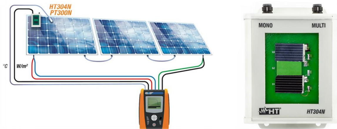
Obr. 1.8: Vlevo – Schéma zapojení analyzátoru HT I-V400W pro měření charakteristik fotovoltaických panelů, vpravo – detail referenčního článku
