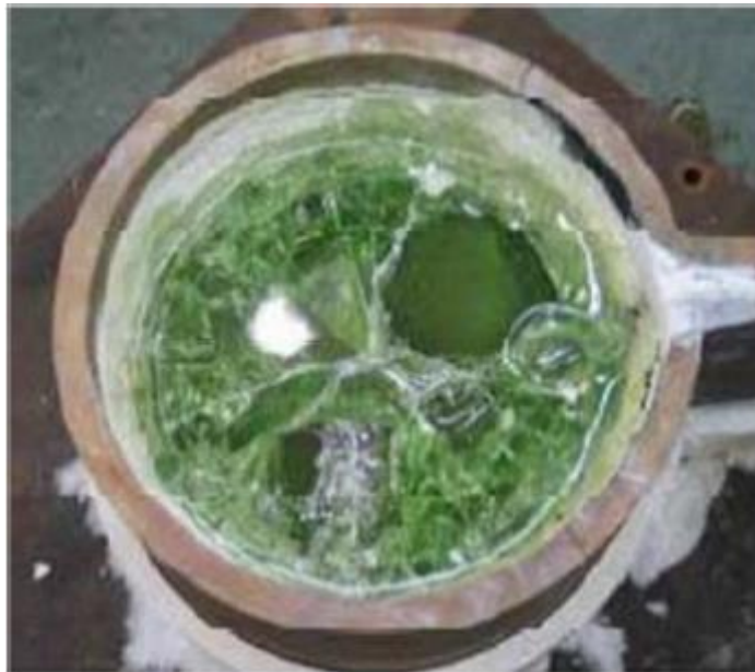
Obr. 9: Vsázka skla po startovací fázi, při které bylo použito plynových hořáků [15].
