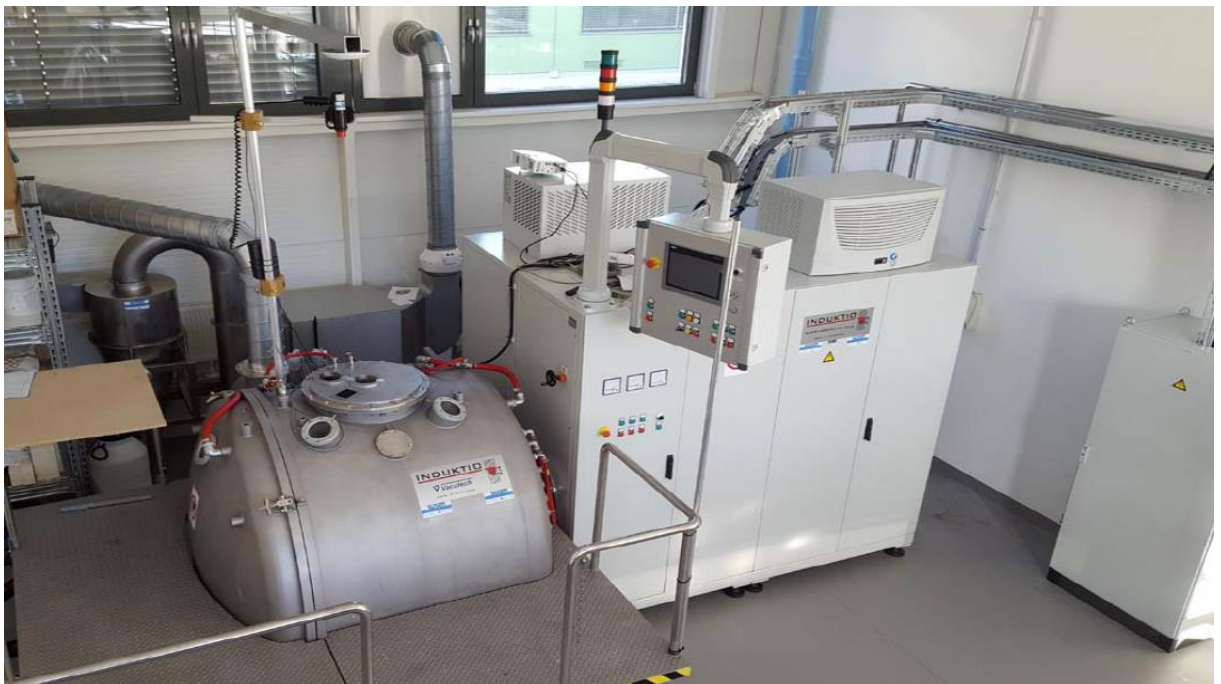
Obr. 20: Zařízení pro tavení ve studeném kelímku [1].
