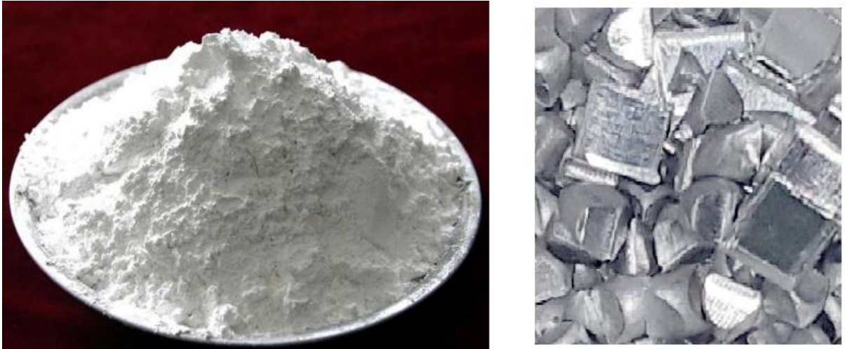
Obr. 6: Oxid hlinitý ( Al_2O_3 ) v prášku (vlevo), kousky hliníku (Al) pro startovací fázi (vpravo) [1], [12].
