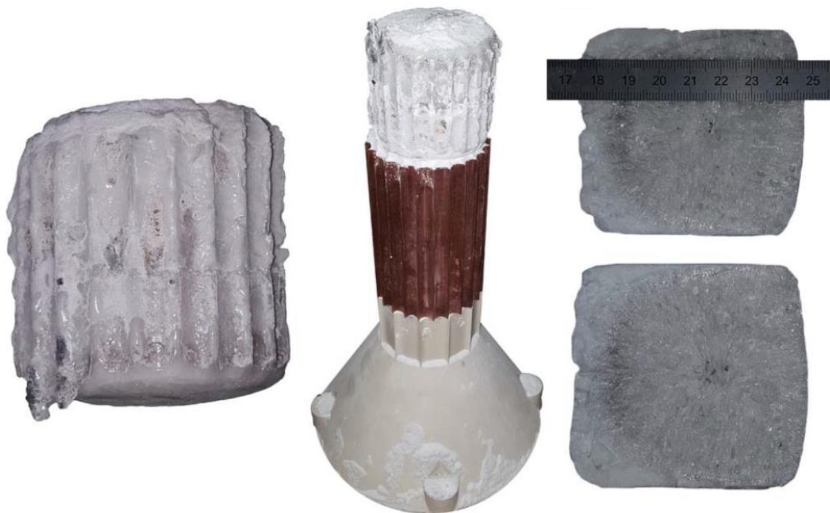
Obr. 3: Vlevo hotový korundový ingot, uprostřed studený kelímek s hotovým ingotem již bez chladících segmentů, vpravo korundový ingot rozdělený napůl [1].
