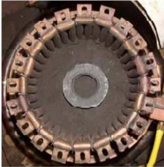
Obr. 8: Prsteneček z vodivého grafitu, který je využit pro nastartování tavby [13].
